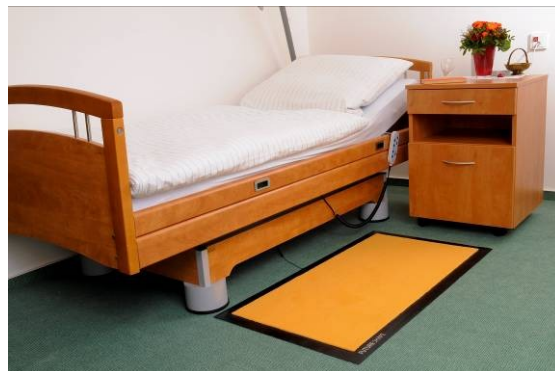
Figure 4 SensFloor Matten enthalten 16 Näherungssensoren und können lokal Schritte erkennen und sie von einem Sturz unterscheiden.
